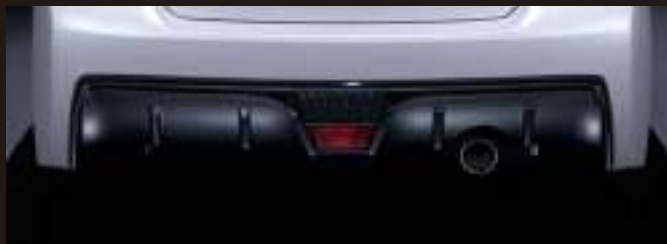
専用リヤバンパー / 専用マフラー (バツフル部)
