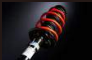
“GR” 専用チューニングサスペンション+ SACHS アブソーバー (約10mm ダウン)
